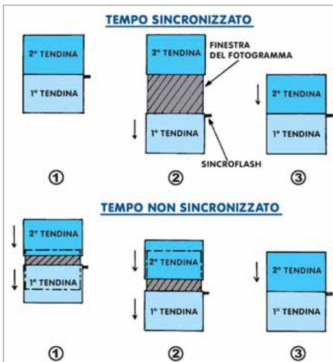
Nel disegno vengono evidenziate le tre fasi principali di otturazioni. Per poter esporre completamente il fotogramma alla luce del flash è necessario che il lampo sia sincronizzato all'apertura massima delle due tendine.
